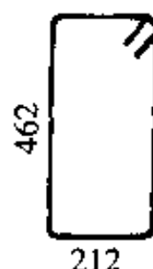
图 5-10 ⑤号箍筋(外包尺寸)
