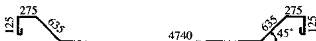
图 5-8 ③号弯起钢筋
